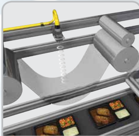
필름 위치 감지 - 장력을 감지하면서 투명 랩의 연속적인 공급을 확인하는 873M 초음파 센서
