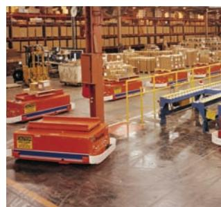
Os tags embutidos no chão orientam o veículo sem motorista através da instalação.
