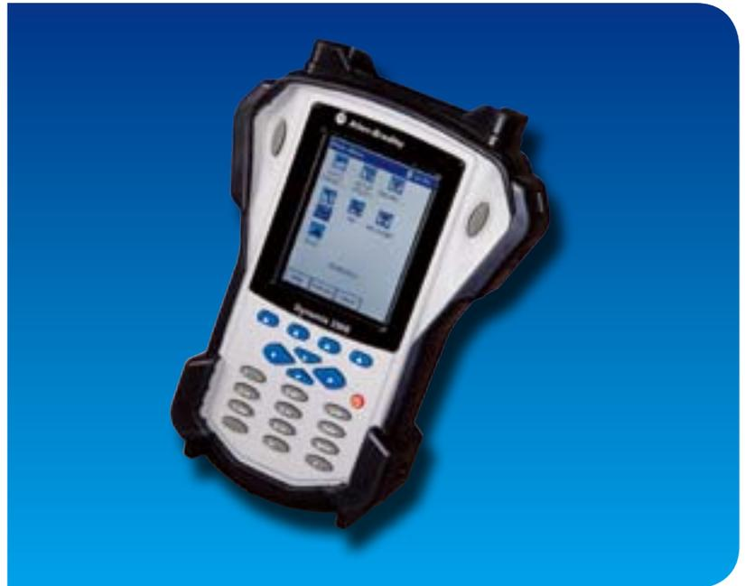
Dynamix 2500数据采集器是实时的多通道的快速傅里叶(FFT)信号分析仪及数据采集器，用于电机、泵、风机、齿轮箱等旋转设备的预测维修和振动诊断。它具备测量、处理、显示和存储等强大的分析功能。既可以独立做分析仪器，您也可以把测量数据上传到您的软件程序进行分析。
