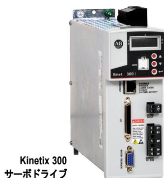
Kinetix 300 EtherNet/IP インデキシングドライブは、軸数の少ないモーション・コントロール・ソリューションにコスト効率のよい 1 軸ソリューションを提供します。Kinetix 300 サーボドライブは、統合アーキテクチャをサポートする CompactLogix コントローラまたはコンポーネント・モーション・ソリューション用の MicroLogix コントローラに接続して動作するように設計されています。マシン（モーション、制御、I/O、および HMI を含む）全体に 1 つの標準 EtherNet/IP ネットワークを使用することで、配線を簡略化して、パネルレイアウトにかかる費用を低減し、製造と企業システムに簡単に統合できるようになります。さらに、安全トルクオフ機能によってマシンの生産性を向上しながら、作業員を安全に保護できます。
