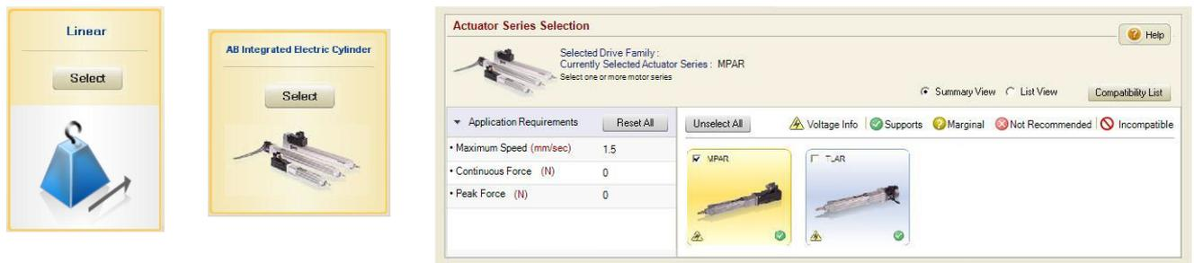
**調整模擬**—此工具能協助您預測機器在真實狀況中的表現。此功能會模擬在 RSLogix 5000 軟體或 IDM 系統應用程式（包括自動調整）調整軸的情況，接著模擬負載、馬達及伺服驅動器的動作。並將機械相容性或反應納入考量，以得出逼真之模擬結果。
