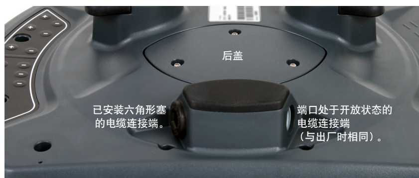
图 4 - MobileView 2711T 终端上的电缆连接端
