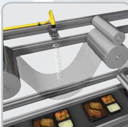
フィルム位置の検出-873M超音波は、 透明な包装紙の連続供給の確認と張 力の監視を同時に行ないます。
