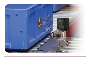
RFID (無線自動識別装置) システムは、製造工程を移動する製品を追跡および記録する機能を備え、高い堅牢性と信頼性を発揮します。これと同様のシステムに、負荷の少ない環境で使用されるバーコードシステムがありますが、産業用 RFID システムは過酷な環境でも使用できる高い耐久性を備えています。さらに、再利用可能なリード / ライトタグは、さまざまな情報やアプリケーションに柔軟に対応できます。ISO 15693 ICODE は、高周波 13.56MHz RFID 向けのオープン規格です。複数の製造メーカによって低価格で提供されている ICODE タグは、多様な形式、製品サイズ、メモリサイズのものがあり、ほとんどのアプリケーションに対応しています。
