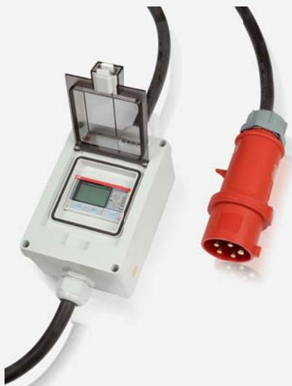
Die Zähler der B-Serie gehören zu einer Basis-Baureihe für Anlagen bis 65 A mit direktem Anschluss oder einem Anschluss über Stromwandler. Sie haben einen großen LCD-Bildschirm mit Hintergrundbeleuchtung. Neben Standardmesswerten wie Strom, Spannung und Wirkleistung zeigen die Geräte je nach Typ auch Scheinleistung, Blindleistung und Frequenz an. Die Zähler der A-Serie verfügen über eine Reihe von Zusatzfunktionen und eignen sich für Anwendungen bis 80 A mit Direkt- oder Wandleranschluss.
