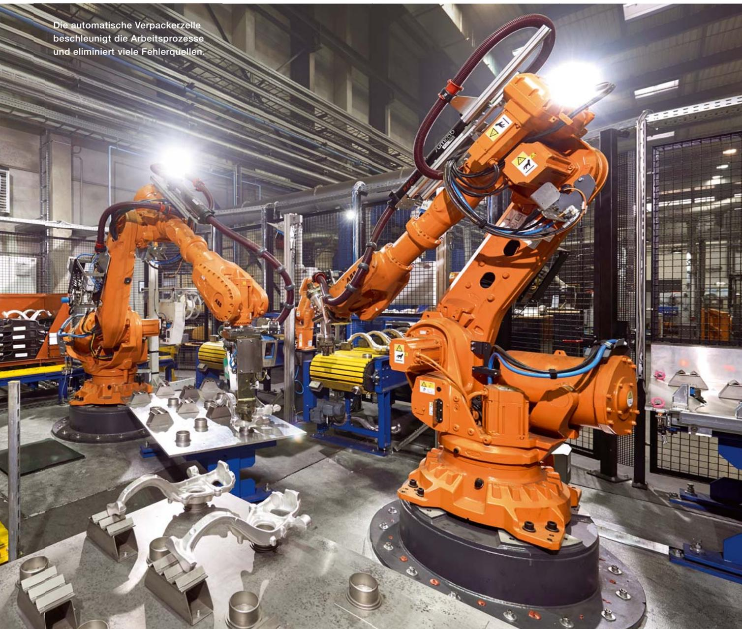
Die Verpackungszeit eines Ladungsträgers beträgt 400 s; dies entspricht einer durchschnittlichen Taktzeit pro Schwenklager von 10 s. „Mit der Verpackungszone können wir die Mitarbeiter deutlich entlasten“, erklärt Erik Schönberg, Projektmanager bei Bharat Forge Aluminiumtechnik. „Sie müssen pro Schicht bis zu 20 t Aluminium handhaben, was sie stark beansprucht.“ Die Verpackungsleistung pro Schicht liegt bei 70 Ladungsträgern.
