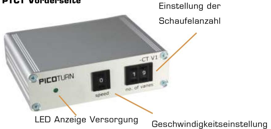
Die Anzahl der Schaufeln auf einem virtuellen Verdichterrad und seine simulierte Drehzahl werden durch Druckknopf-Kodierschalter ausgewählt.
