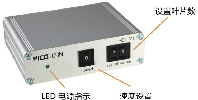
在一个虚拟压缩机轮上的叶片数以及它的模拟转速都可以通过按键码开关选择
