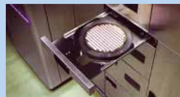
切断状況を確認するインスペクションステージ
