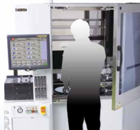
大型ドアと広い加工室によりメンテナンス性を改善
