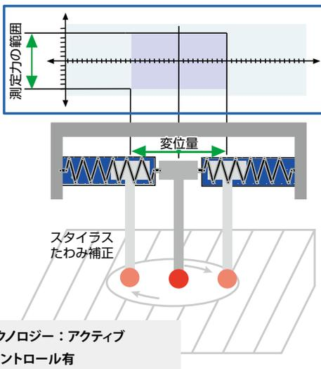
電磁力により一定の小さな測定力を発生させ、ワークの法線方向に測定力をかけます。そのため、スタイラスのたわみ量が小さく、かつ一定で精度が向上します。
