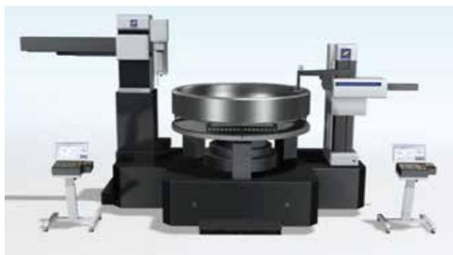
真円度でアライメントを取れば輪郭粗さの測定が簡単にできます。
