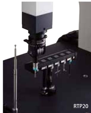
三次元測定機の動力を利用した自動首振りヘッドで、TP20を内蔵しています。(水平/垂直回転角度 15°ピッチ)
