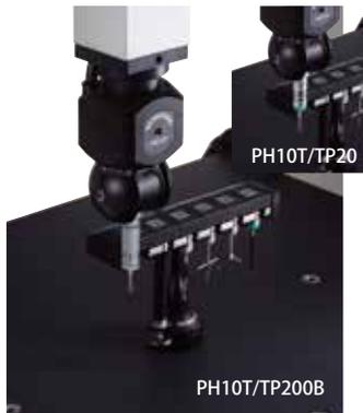
最大 300 mm エクステンションに対応する自動首振りヘッドです。水平回転角度は±180°、垂直回転は0°~+105°で、7.5°ピッチで位置決めが可能です。TP200B仕様では、スタイラス長さ最大 100 mm (GF スタイラス使用時)。エクステンションバー最大 200 mm 使用可。
