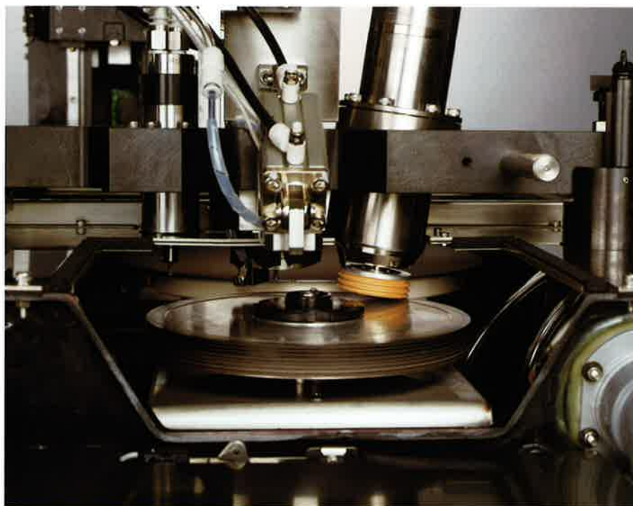
外周低歪研削機構、ノッチ高速スピンドル付加工部
