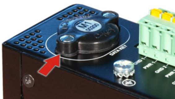
Pour monter une nouvelle C-Key, assurez-vous que le méplat est bien orienté vers l'arrière du boîtier, puis insérez la verticalement, sans forcer, dans l'ouverture, et vissez.
