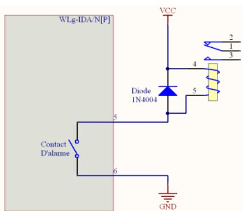
Le contact utilisé peut commuter au maximum une tension de 60V et un courant de 150mA.
