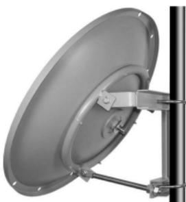
Pour une installation de type tilt up (parabole pointant vers le haut) la tige filetée de réglage du tilt doit se trouver en bas (voir ci-contre). En revanche pour une installation du type tilt down (parabole pointant vers le bas) la tige filetée de réglage doit se trouver en haut.
