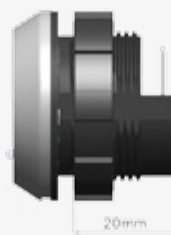
Le modèle fin peut être installé avec moins de 20mm d'espace arrière disponible.
