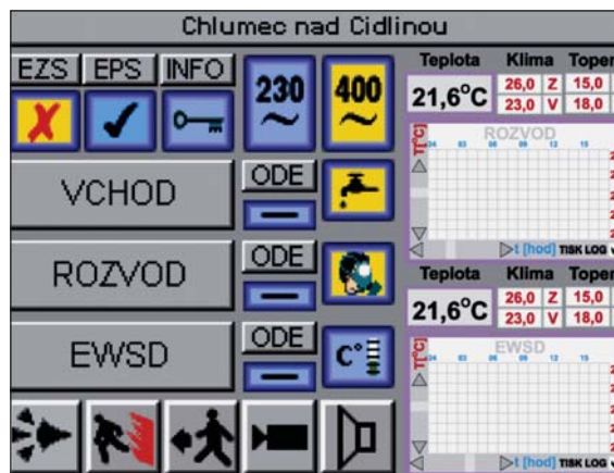
Ovládací panel vzdáleného objektu.
