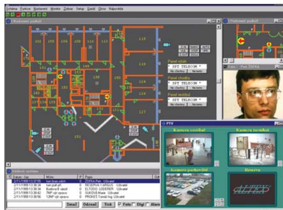
Náhled na dialog lokální instalace v systému ALTEX s integrovanými soubory IVS, EZS, EPS a CCTV.
