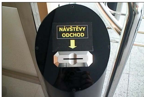
Pohled na řešení kontroly vstupu s osazeným odebráčem karet RDR-VIS-BOX a jeho detail.
