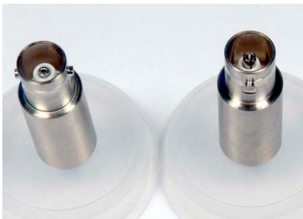
Schwierig zu unterscheiden: BNC und MHV sehen sehr ähnlich aus. Links ist BNC, rechts MHV. Der auffälligste Unterschied ist die zurückgesetzte Keramik bei der MHV Buchse.
