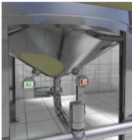
为了确保最佳清洗效果，必须精确监测罐内洗涤剂的温度，以实现质量稳定的清洗过程，并最终保证食品安全。
