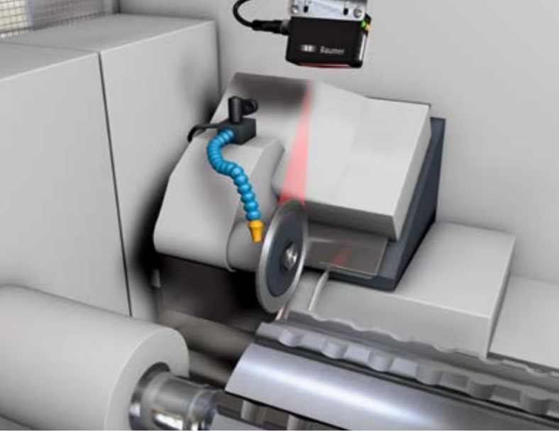
测量数控机床的砂轮直径
