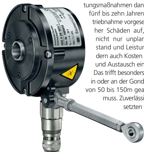
Bild 2: Der Heavy-Duty-Inkrementaldrehgeber liefert je Umdrehung bis zu 2.500 Impulse und ist mit 97mm Durchmesser sehr kompakt gebaut.
