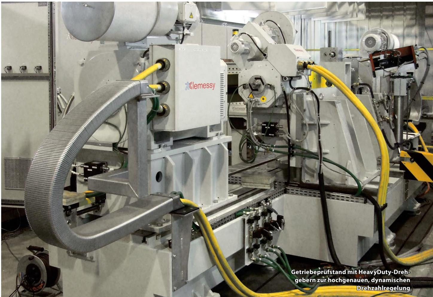
Getriebeprüfstand mit HeavyDuty-Drehgebern zur hochgenauen, dynamischen Drehzahlregelung
