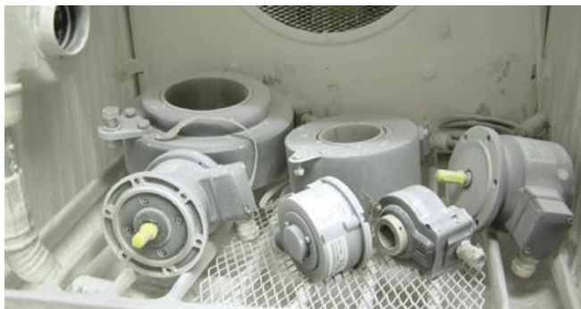
Bild 6: In der Staubkammer werden die Drehgeber eingeblasenem Quarzmehl ausgesetzt
