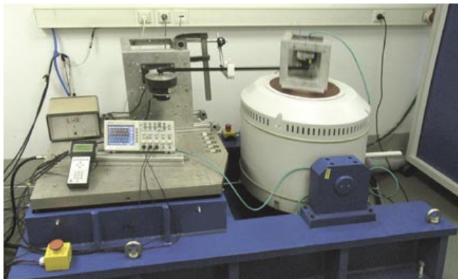
Bild 5: Schwingungsprüfung des aktiv betriebenen Drehgebers (rechts) in x-, y- und z-Richtung
