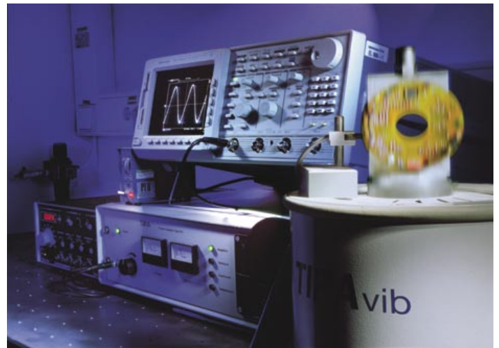
Bild 3: Bestückte Leiterplatten werden auf Resonanzfrequenzen untersucht
