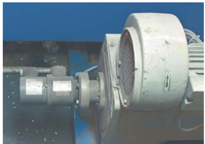
4: Die Kombination TDP 0,2 + FSL aus Tachogenerator und Fliehkraftschalter versieht trotz hoher Staubeinwirkung zuverlässig ihren Dienst an einer Endlosdruckmaschine
