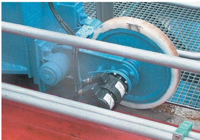
**5: Zwillingsgeber des Typs POG 10G mit Euro-Flansch B10 und zwei getrennten Abtast-Systemen an den Antrieben eines Containerkrans**
