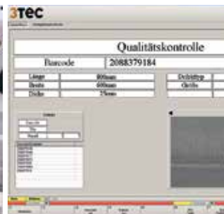
Anzeige des fehlerhaften Bauteils am Nacharbeitsplatz.
