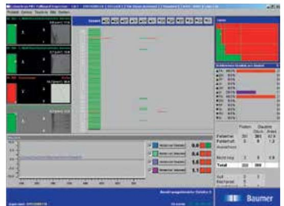
*Q-brain*® ist das neuartige Klassifikationssystem von Baumer Inspection. Mit *Q-brain*® werden Fehlerbilder nach Ursachen und Fehlerarten sortiert, zwischen Einzelfehlern und prozessverursachten Fehlern unterschieden und eine aufliegende Verschmutzung von einem echten Fehler getrennt.
