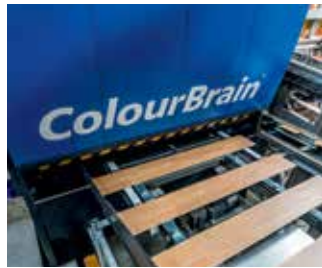
Inspektion nach der Profilierung.
