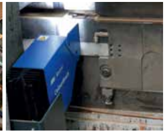
Kontrolle der Fasenlackierung.
