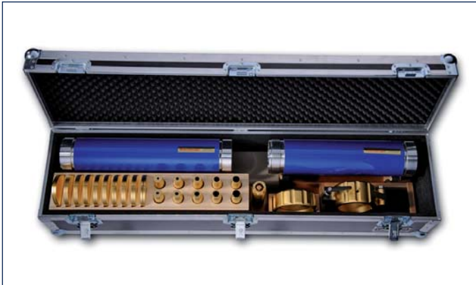
Bild 8: Messeinrichtung CoMeT 90, Lieferumfang Koffer 1 von 2
