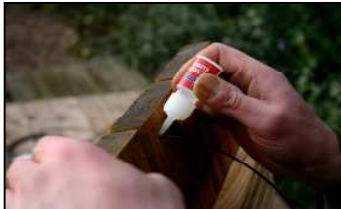
Fixieren des Lichtleitkabels auf der Holzrückseite mit z.B. Sekundenkleber
