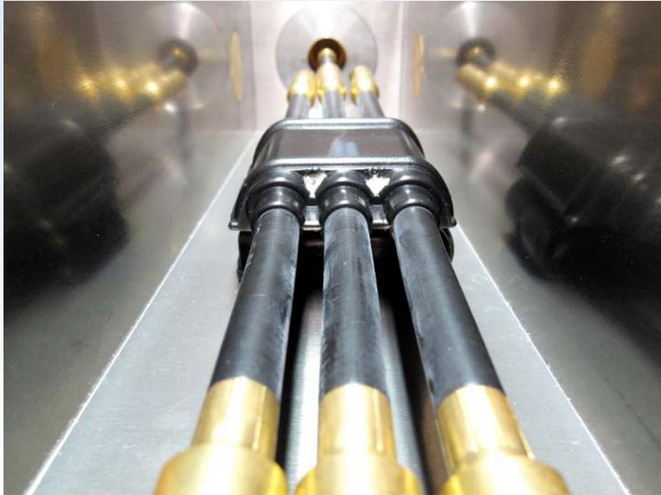
Messen der Schirmwirkung elektrischer Kabel
