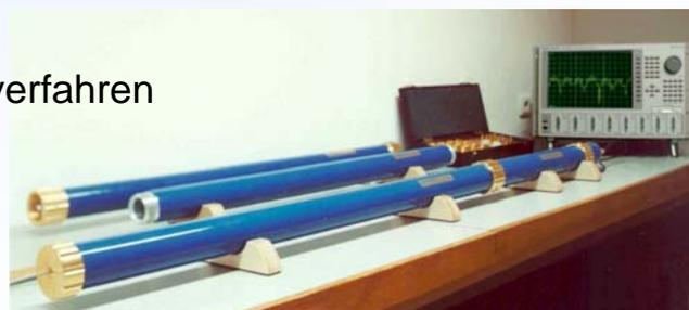
Messen der Schirmwirkung elektrischer Kabel
