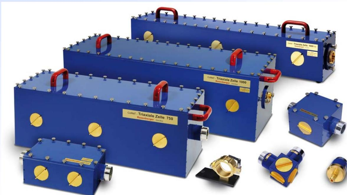
Messen der Schirmwirkung elektrischer Kabel
