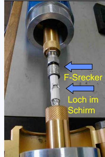
Messen der Schirmwirkung elektrischer Kabel
