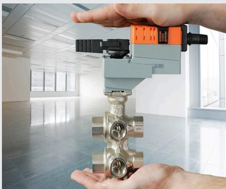
Das 6-Weg-Zonenventil dient der Regelung eines kombinierten Heiz-/Kühlelements im 4-Leiter-System. Seine einzigartige Technologie revolutioniert die Bauweise dieser Systeme und ersetzt vier 2-Weg-Ventile, vier Stellantriebe und zwei Regelsteuerungen.
