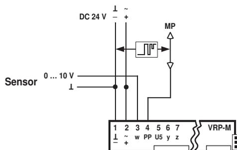
Aktive 0 ... 10 V Fühler für Regel- und Steuerfunktionen im übergeordneten System, z.B. Feuchtfühler, CO<sub>2</sub>-Sensoren. Bei der Implementierung ist die Zykluszeit zu beachten! Einstellung Führungssignal w für aktive Fühler-Einbindung: 0 ... 10 V
