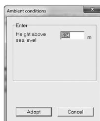
Über die Einstellmarke «Umgebungsbedingungen» im Register Experte lässt sich die Höhe über Meeresspiegel als relevanten Parameter als Korrekturwert für das VFD3-Signal eingeben:
