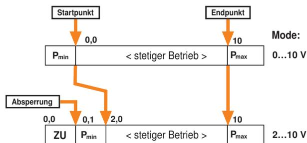
Im Mode 2 ... 10 V kann durch das Absenken des Führungssignals auf 0,0 V ein Absperrbetrieb (Klappe ZU) realisiert werden.
