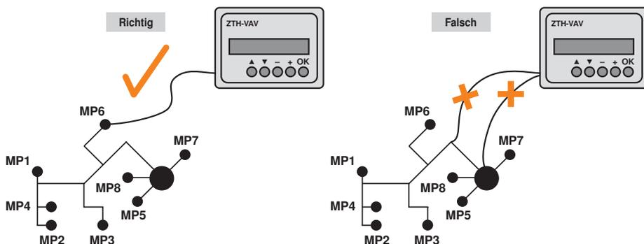
Der Direktanschluss auf den MP-Bus oder MP-Master ist mit dem ZTH-GEN nicht möglich. Lösung: Servicebuchse am VAV-Regler benutzen oder den MP-Anschluss des MP-Gerätes temporär vom MP-Bus trennen und das ZTH-GEN an den MP-Anschluss anschliessen.
