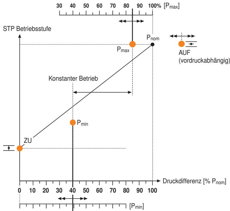
**STP – stetiger Betrieb mit Übersteuerung**
