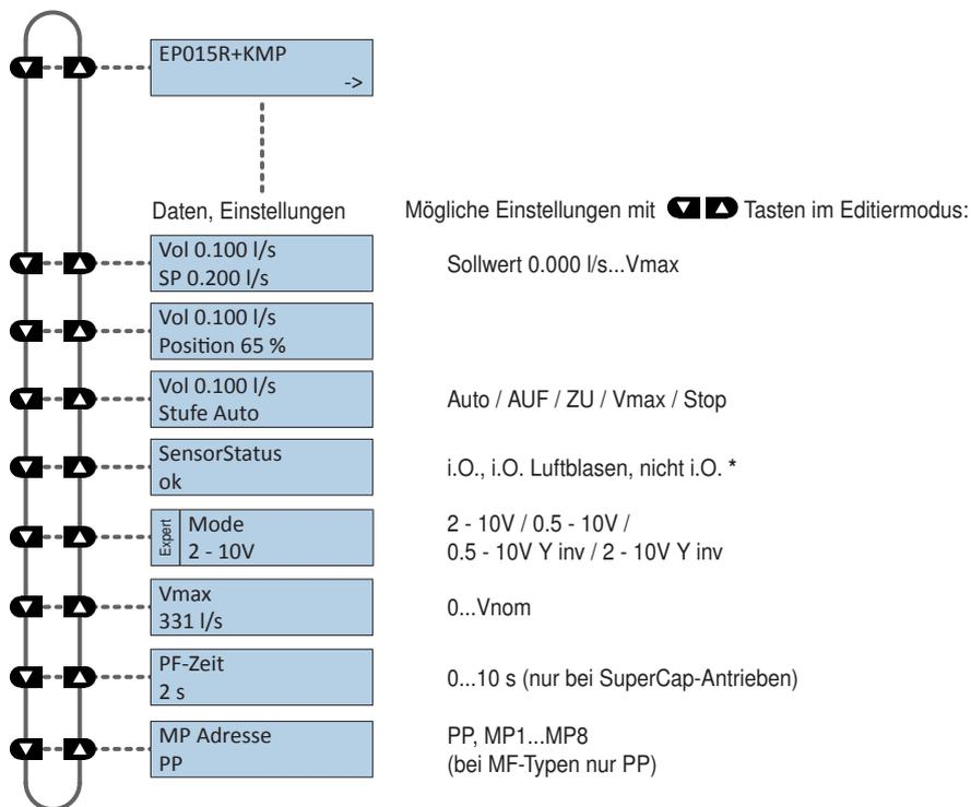
\* i.O.: Durchflussfühler arbeitet korrekt
