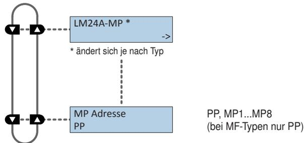
**Modbus-Antriebe** Modbus-spezifische Kommunikationseinstellungen eines Antriebs mit integrierter Modbus-Schnittstelle (...MOD).
