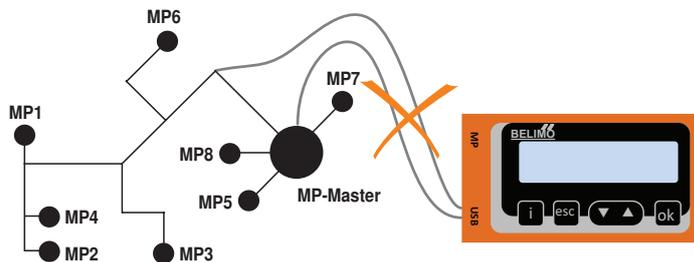
Lösung: Servicebuchse am Antrieb benutzen oder den MP-Anschluss des MP-Geräts temporär vom MP-Bus trennen und das ZTH EU an den MP-Anschluss anschliessen.
