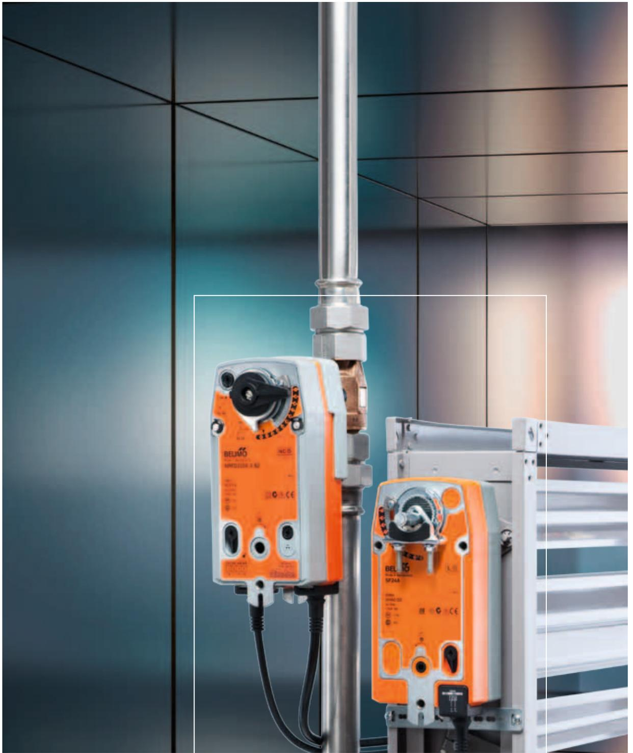
Die Federrücklaufantriebe wurden für unterschiedliche Anforderungen entwickelt und erlauben bei jeder Anwendung die wirtschaftlich sinnvollste Motorisierungslösung. Das eingebaute mechanische Federrücklaufpaket fährt die Stellglieder wenn nötig sofort in die erforderliche Notstellposition. Ventilantriebe mit elektrisch geregelten Zwangsfunktionen schützen gleichzeitig die Heizregister wirkungsvoll vor kostspieligen Frostschäden.
