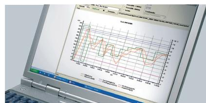
**Belimo PC-Tool.** Das bewährte PC-Tool ermöglicht die komplette Bedienung, Funktionskontrolle und Einstellung der VAV-Compact-Einheiten. Trendfunktionen mit grafischen Darstellungen erleichtern die Überprüfung. Alle Parametrier- und Istwerte können gespeichert sowie jederzeit off- oder online ausgedruckt werden.
