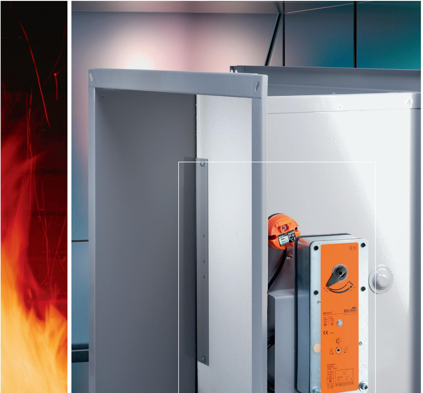
Motorisierte Brandschutzklappen sind Absperrvorrichtungen gegen die Übertragung von Feuer und Rauch in Lüftungsanlagen. Sie schützen im Brandfall Menschen und Sachwerte. Brandschutzklappen sind mit einer thermoelektrischen Auslöseeinrichtung ausgerüstet. Um eine Rauchübertragung zu verhindern, können sie zusätzlich durch Rauchmelder ausgelöst werden. Die Motorisierung erfolgt mit Belimo Brandschutz-Sicherheitsantrieben.
