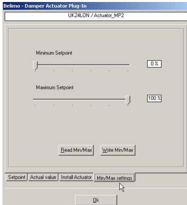
Diese Plug-In Seite kann verwendet werden um je nach Antriebstyp den Drehwinkel - , den Hub - oder den Volumenstrom minimal - oder maximal zu begrenzen. An den Schiebezeigern kann ein Min - oder Max-Wert definiert werden. Durch Wahl des Knopfes "Read Min/Max werden die am Antrieb eingestellten Werte aus dem Antrieb gelesen und bei Wahl des Knopfes "Write Min/Max entsprechend in den Antrieb geschrieben.
