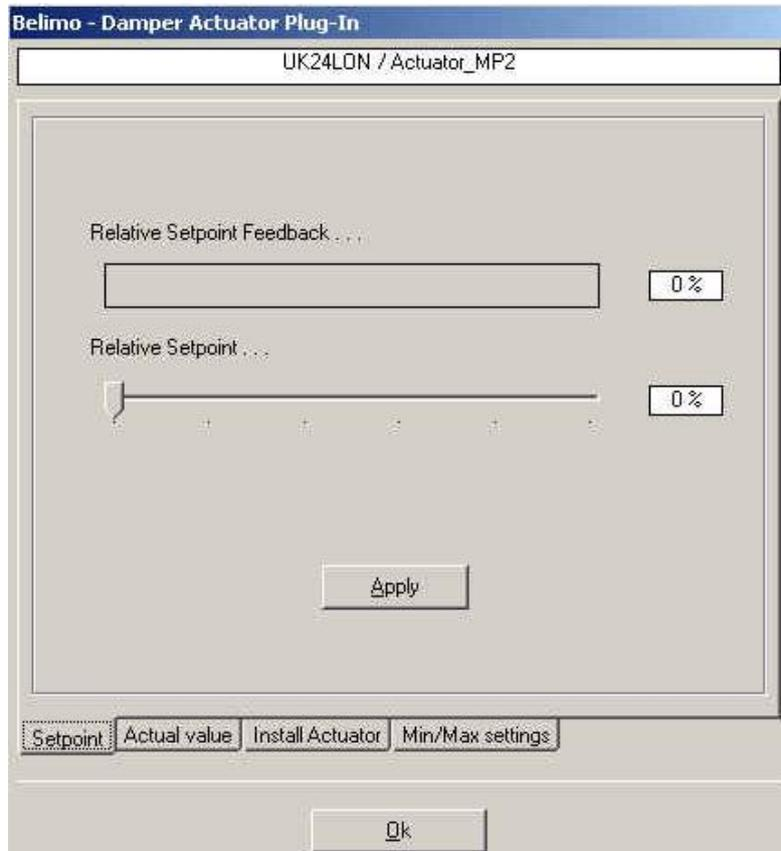
Diese Plug-In Seite kann beispielsweise dazu verwendet werden, um dem Antrieb zu Testzwecken bei der Inbetriebnahme einen bestimmten Sollwert (0...100 %) vorzugeben. Der mit dem Schiebezeiger vorgegebene Sollwert wirkt auf den SNVT `nviRelStpt` (SNVT\_lev\_percent) des Funktionsblockes.
