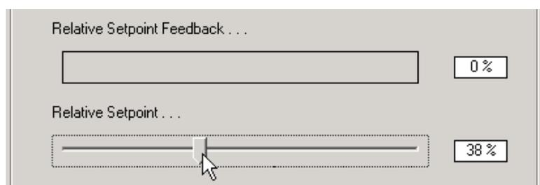
Sobald der Knopf "Apply" betätigt wird, zeigt der "Feedback-Balken" den entsprechenden Wert an.
