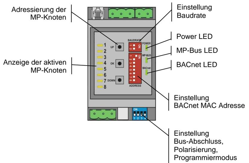
Die Abbildung zeigt die Bedienungselemente des Gerätes bei geöffneter Frontabdeckung.
