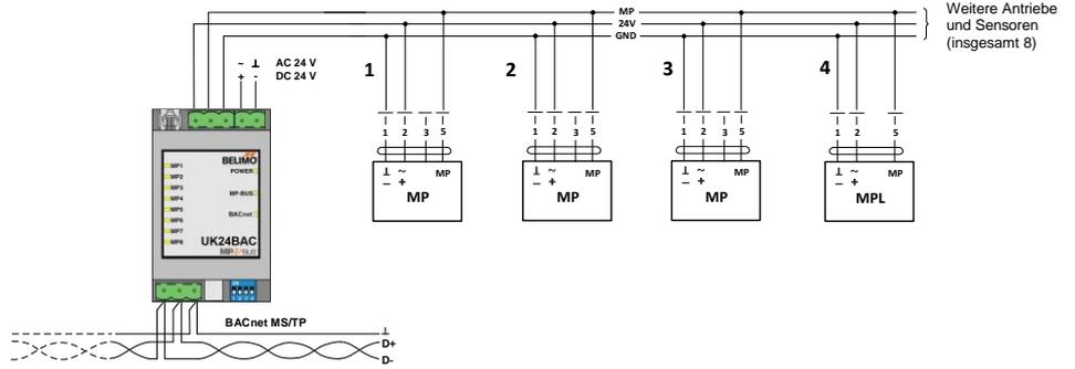
Die Verdrahtung von BACnet MS/TP (RS485) hat nach den einschlägigen Richtlinien zu erfolgen. Das Gerät besitzt zuschaltbare Widerstände für Bus-Abschluss und Polarisierung. Der GND der RS485-Linie ist vom MP-Bus GND galvanisch getrennt. Für gebäudeübergreifende Segmente ist eine zusätzliche galvanisch Trennung vorzusehen (z.B. Repeater, Glasfaser-Link).
