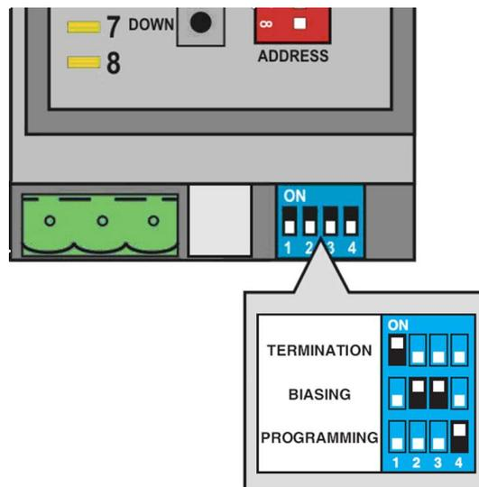
Zur Reduktion von Störeinflüssen in Kommunikationspausen kann die RS485-Leitung mit zwei Widerständen polarisiert werden (DIP-Schalter 2 und 3). Die Polarisierung erfolgt in der Regel an einem der Bus-Enden. Die Schalter 2 und 3 müssen immer zusammen aktiviert resp. deaktiviert werden.
