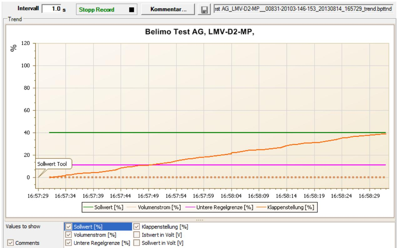
Trend-Diagramm für Regelfunktion "Open Loop"
