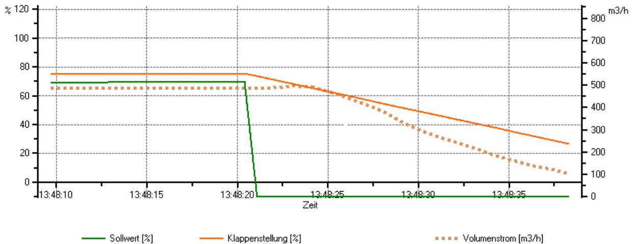
Trend-Diagramm für Regelfunktion "Open-Loop"
