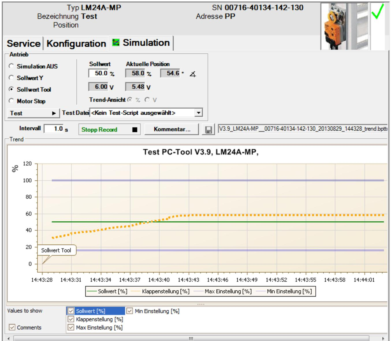
Register "Simulation" für Klappenantriebe
