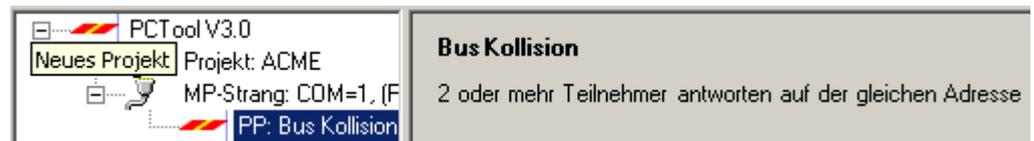
Wenn beim Bus Scan ein aktiver Fremdmaster erkannt wird, wird der Strang geschlossen. Diese Situation wird vom Programm mit einer entsprechenden Meldung angezeigt.
