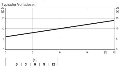
[d] = Spannungsunterbruch in Tagen [s] = Vorladezeit in Sekunden
