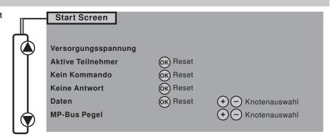
Mit der Taste OK werden die aktuellen Resultate gelöscht und die jeweilige Überprüfungssequenz neu gestartet.
