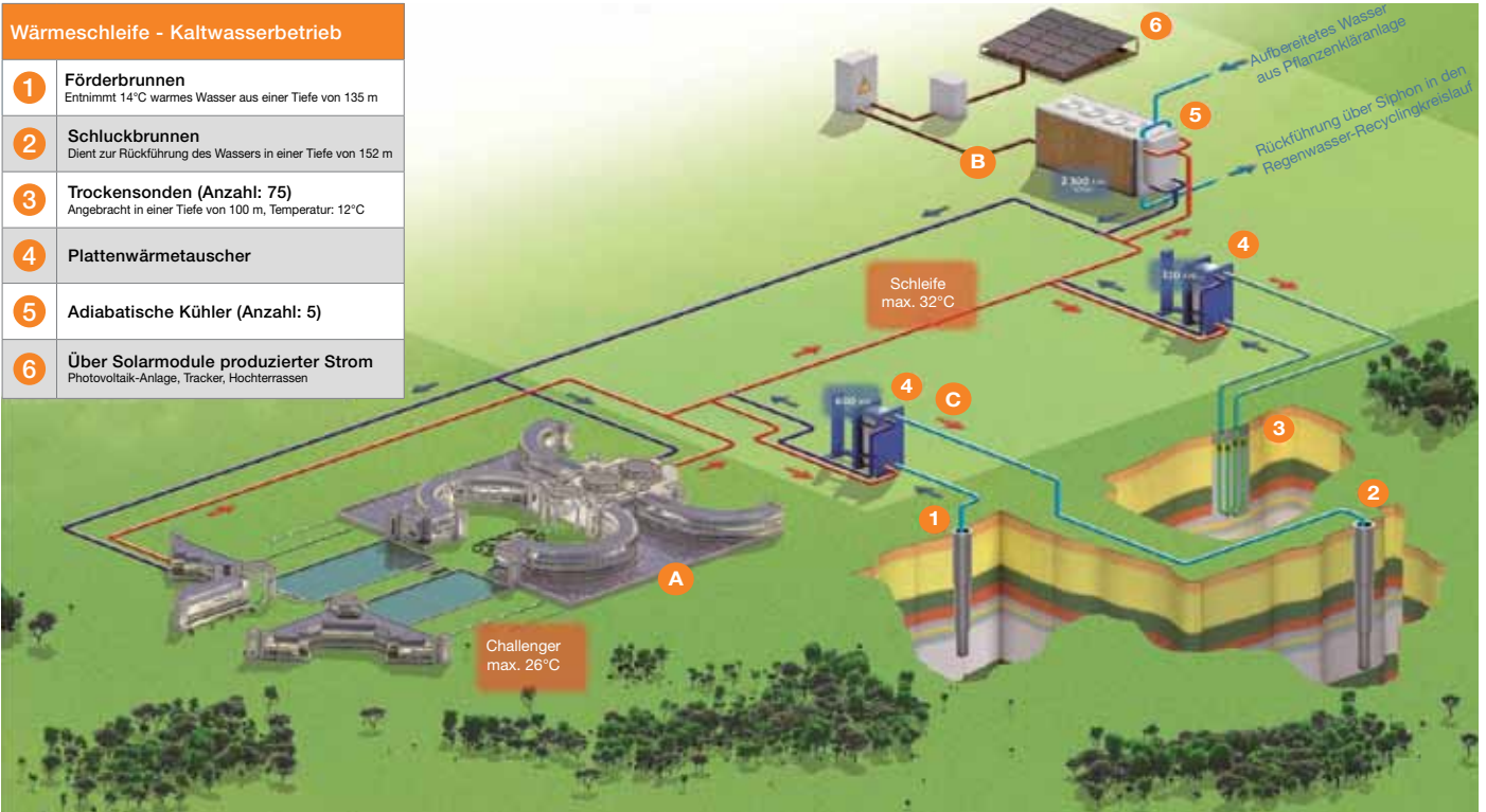
Das Challenger-Areal mit den Anwendungsbereichen des Belimo Energy Valve™ im Kälte- und Wärmekreislauf
