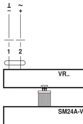
Die steckerfertige Betriebseinheit wird mit dem 3-poligen Stecker an den VR..-Regler angeschlossen.
