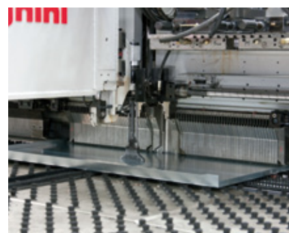
Plåten till huven skärs ut och bockas efter huvens specifikationer.
