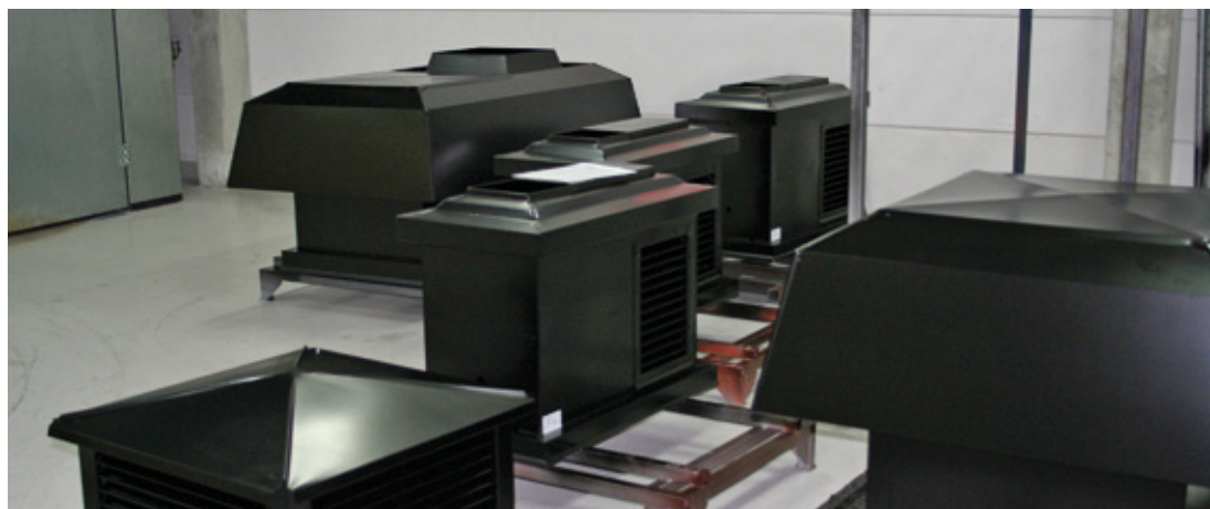
Takhuvar som nyligen pulverlackerats i korrosivitetsklass C4 och härdats i vår värmeugn.
