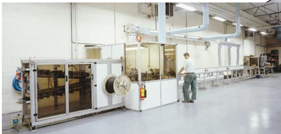
Patenterad tillverkning av spjällblad. I en högautomatiserad maskin valsas, profileras och sammanfogas "ändlösa" spjällblad.
